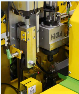
Précis: Double tête de coupe avec système de séparation par cutter
