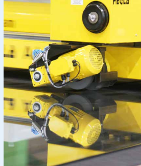
Automatique: Emargeage avec la double tête TWIN
