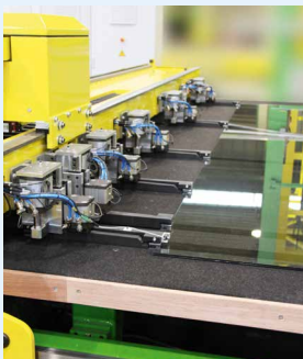
Positionnement précis: Pincés doubles permettant de pousser ou de tirer les volumes (AdvaLam)
