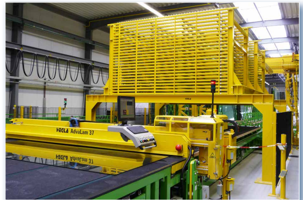
Stockage intermédiaire des résiduels au-dessus de l'installation de coupe
