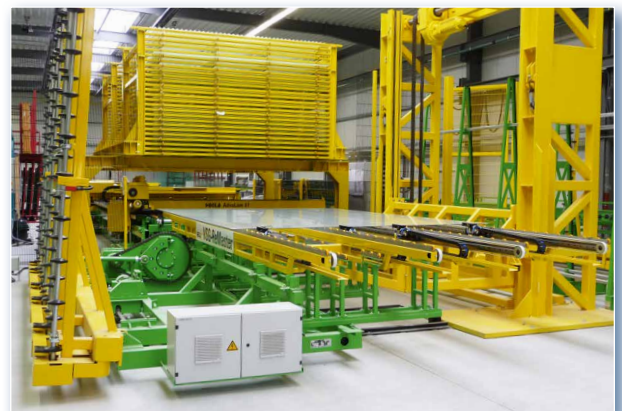
Par un process automatisé, absence de manipulation: station de levage et de transport pour ReMaster
