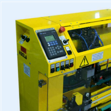
Affichage des états de fonctionnement sur le panneau de visualisation
