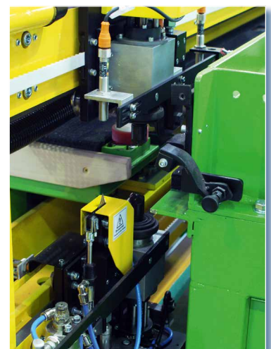
Double têtes de coupe pour des traits de coupes supérieurs et inférieurs très précis. Système de séparation et cutter pour une coupe rapide et propre du film.
